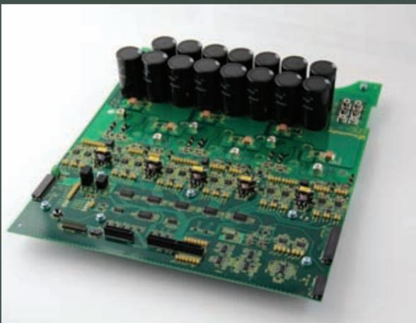
L'efficienza massima dell'inverter messo a punto nel corso della ricerca è stata pari al 98,8%, mentre, grazie all'utilizzo di meccanismi e componenti elettromeccanici più piccoli, è stato possibile ottenere una notevole riduzione del volume. Grazie a questi fattori il peso totale raggiunto in laboratorio, compreso l'alloggio, è pari a 58,5 kg con una capacità dello spazio di installazione di 110 litri.
