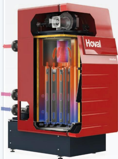
Hoval UltraGas è la caldaia a condensazione di Hoval che, grazie ad alcuni dettagli tecnici, quali lo scambiatore di calore aluFer, mira a ricavare una maggiore energia dai gas di scarico e ad aumentare il rendimento. Hoval UltraGas mantiene separati gli attacchi del ritorno per alta e bassa temperatura mentre il bruciatore modulante UltraClea contribuisce ad adattare in modo continuo la potenza al fabbisogno
